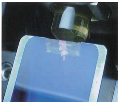
▲ デルタ・ナイフで面出し後、ヒストダイヤモンドナイフで切削しているところ
